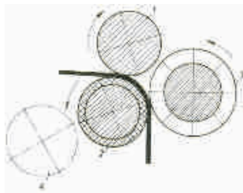
Figura nr. 18 - Skema e makinës për heqjen e epidermës dhe qimeve: 1) rrotulluesja e sipërme transportuese, 2) rrotulluese e gomës në pozitë kur makina punon, 3) rrotulluesja me thika; 4) rrotulluese gome në pozitë të lirë.
