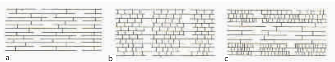
Figura nr. 27 – Formimi i lidhjeve në strukturën e kolagjenit: a) para regjje, b) sipas rregullës regjës të thellë, c) regjje e vdekur
